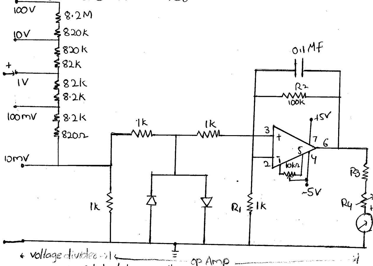
Fig: Solid state mv voltmeter
